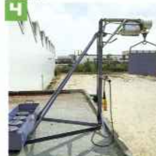
Supporto a tripiede con contenitore contrappeso per tetti piani e terrazze che può essere smontato per un più facile trasporto.
