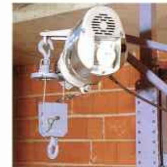
La portata del GEDA-MINI 75/150 può venire raddoppiata bloccando la puleggia.
