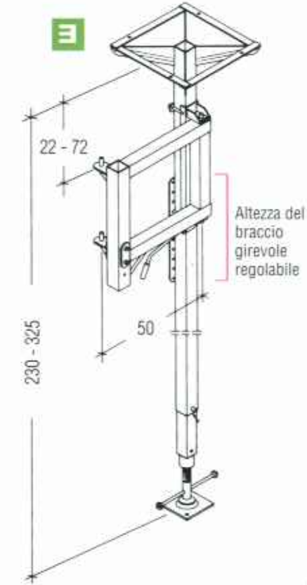
Supporto per fissaggio a ponteggi tubolari da 1 1/2" adatto a tutti gli argani a braccio girevole GEDA .
