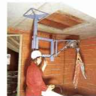
Il supporto da terra al soffitto permette di lavorare anche in condizioni difficili (per esempio su scale)
