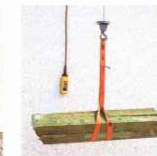
Imbragatura per sollevamento materiali pesanti lunghi 1,5 m.
